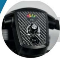
Painel com indicador de nível de bateria, controlador de velocidade e buzina
