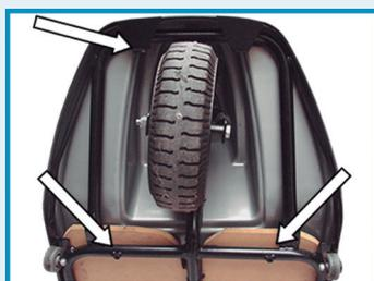
Para fixar o suporte retire o banco, a carenagem central e as baterias. Levante o Scooter SMB, segurando-o firmemente pelas barras do chassi que se encontram sob a carenagem, colocando-o em pé sobre o para-choque.
